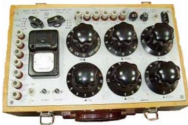
Рисунок 5.1. Мост постоянного тока МО-62
